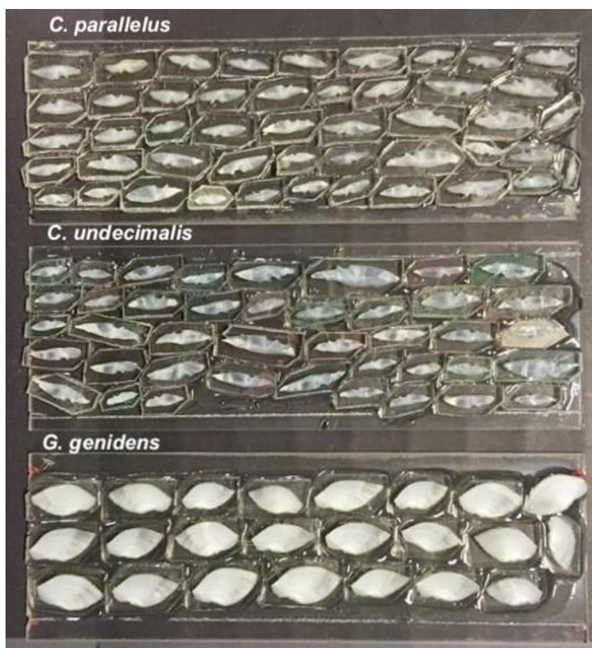
Figura 13: Lâminas de vidro contendo os otólitos para análise no LA-ICP-MS
