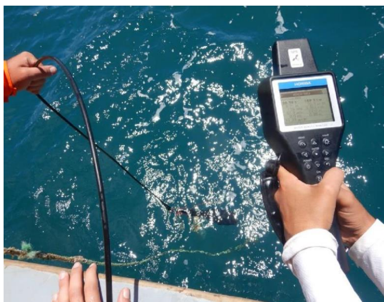
Figura 3: Coleta de dados em campo para mensuração das variáveis ambientais utilizando sonda multiparâmetro
